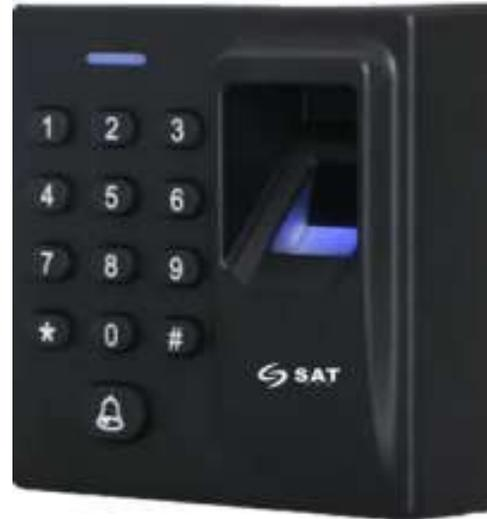
El CX100 es un lector biométrico compacto para control de acceso que incorpora un rápido y preciso algoritmo de identificación de huellas digitales. Está diseñado para aplicaciones sencillas de control de acceso, soportando la conexión de una cerradura eléctrica, botón de salida, sensor de puerta, salida de alarma y timbre. Cuenta con lector de huellas digitales, lector de tarjetas ID y teclado.
